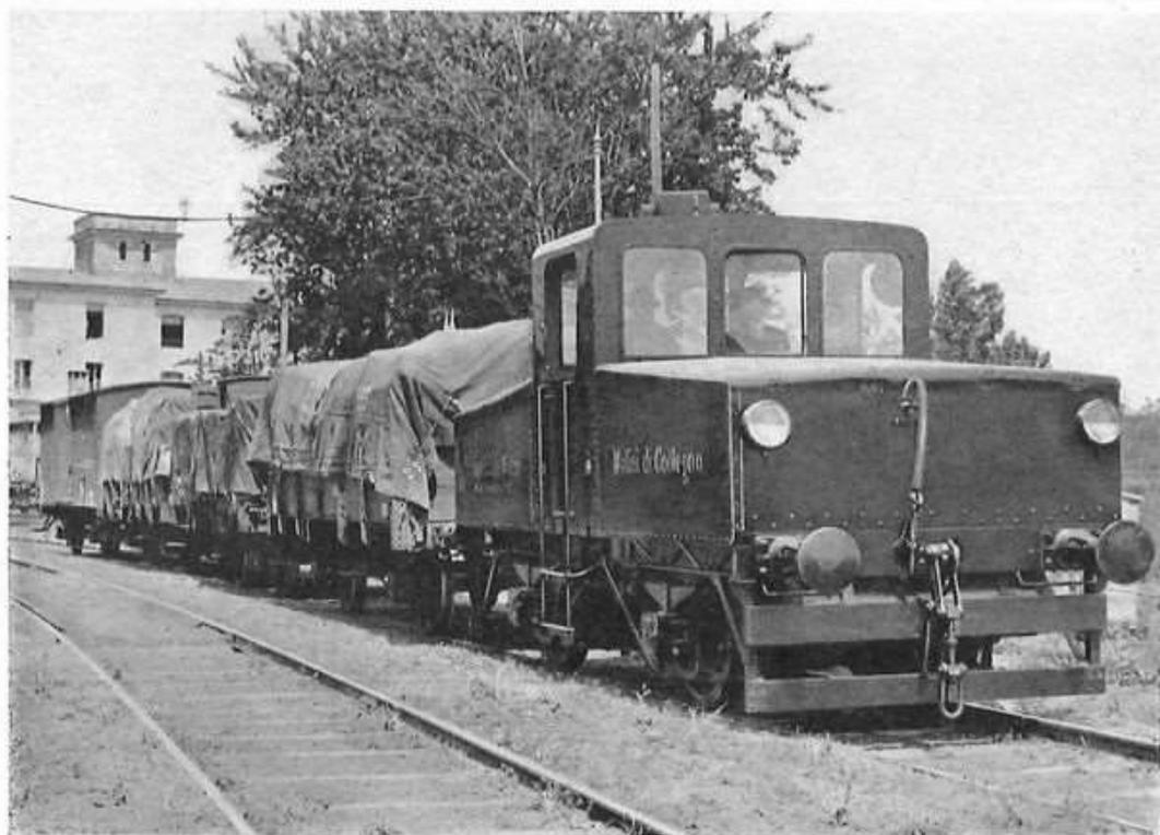
Locomotore elettrico azionato da accumulatori *Tudor*, in servizio di manovra e raccordo ferroviario presso la Società Esercizi Molini a Cologno.
