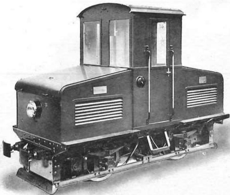
Uno dei 2 locomotori elettrici azionati da accumulatori *Tudor*, in servizio presso la Soc. An. Stabilimenti di Dalmine. (Parco di 8 locomotori)
