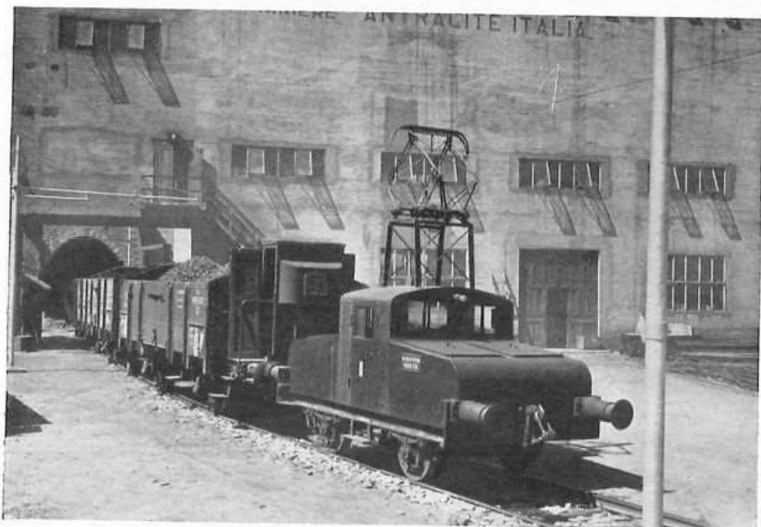
Locomotori elettrici ad alimentazione mista, azionati da accumulatori *Tudor*, in servizio presso la S. A. « Cogne » Valdigna d'Aosta.
