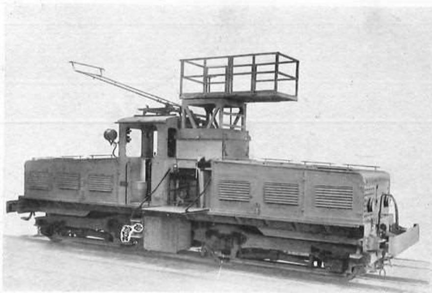
Locomotore elettrico azionato da accumulatori *Tudor*, in servizio presso la Soc. An. per le Strade Ferrate Secondarie Meridionali di Napoli, per manovra e manutenzione linea di contatto nella rete della Ferrovia Circumvesuviana.
