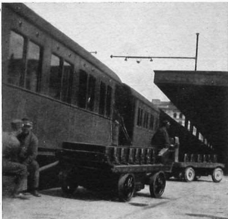
Carrelli elettrici azionati da accumulatori *Tudor*, in servizio presso le Ferrovie Nord-Milano per il trasporto delle batterie per la illuminazione delle carrozze.
