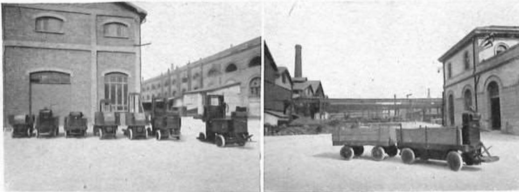
Carro automotore, trattore e carrelli elettrici azionati da accumulatori *Tudor*, in servizio presso la Soc. "Terni" ("Stabilimenti Siderurgici").
