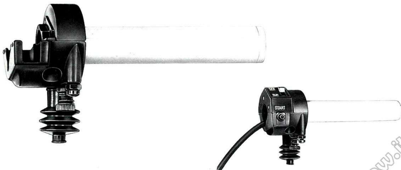
ART. 511 Mod. "DAYTONA EL" - Comando \varnothing 22 , fusione in lega di alluminio magnesio, color nero, completo di soffiETTO vite fine corsa e vite frizione per indurire o rendere più scorrevole il comando. Lo stesso viene fornito privo di manopole e possono essere adattati tutti i tipi di ns. manopole. Il comando è predisposto per essere completato con dispositivi CEV dis. 81.82 - 81.82.1
