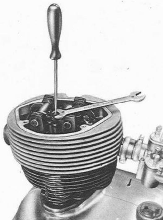
Fig. 3 - Schema registrazione gioco delle valvole.
