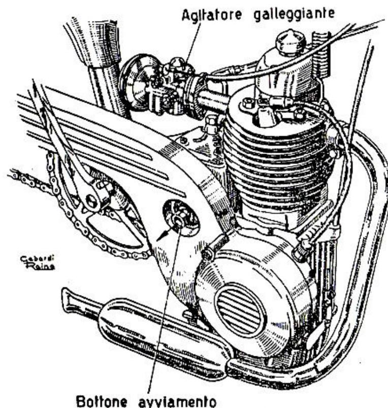
Fig. 3. - Bottone di avviamento - Agitatore del galleggiante del carburatore.
