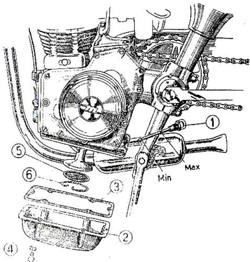
Fig. 4. - Astina controllo livello olio - Coppa smontata per ricambio dell'olio e pulizia del filtro.
