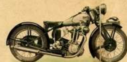
Mod. 121 SS 2 tubi scarico 4 velocità
