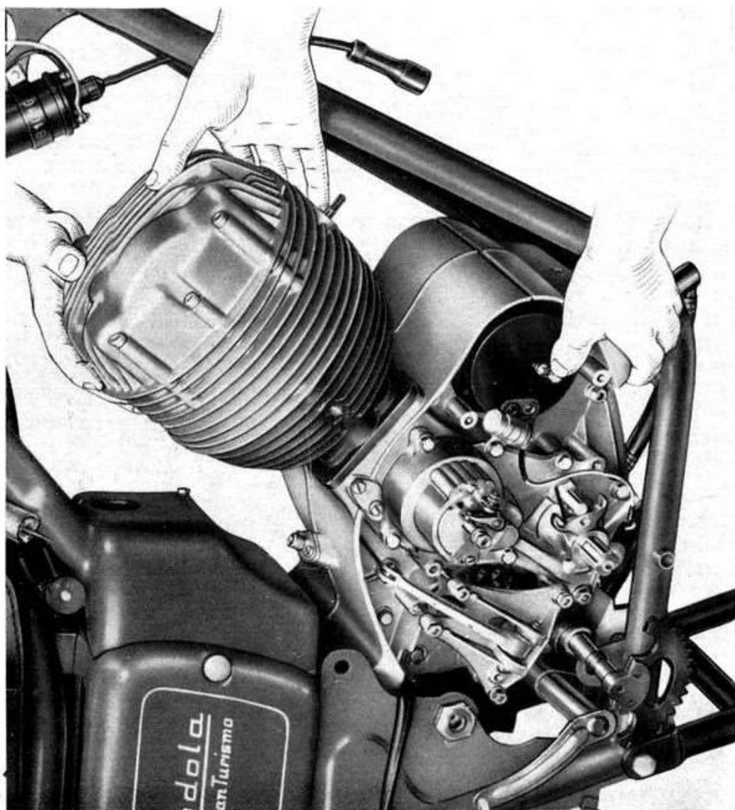
Fig. 27 - Come viene tolto il motore dal telaio.
