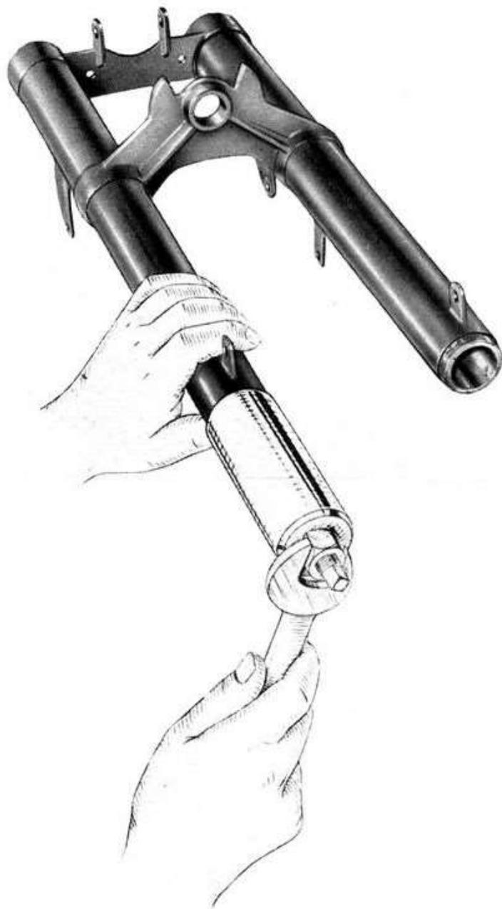
**Fig. 63 - Estrazione delle bocche inferiori dalla forcella telescopica.**
