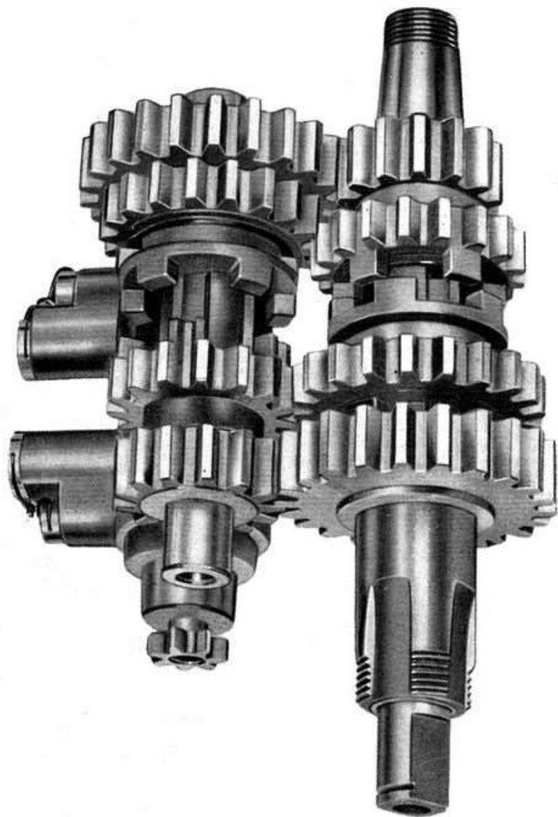
Fig. 38 - Gruppo cambio montato in 1ª velocità.
