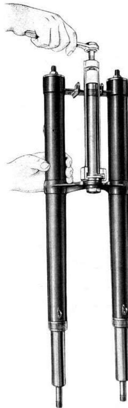
**Fig. 61 - Estrazione della calotta inferiore del canotto sterzo.**
