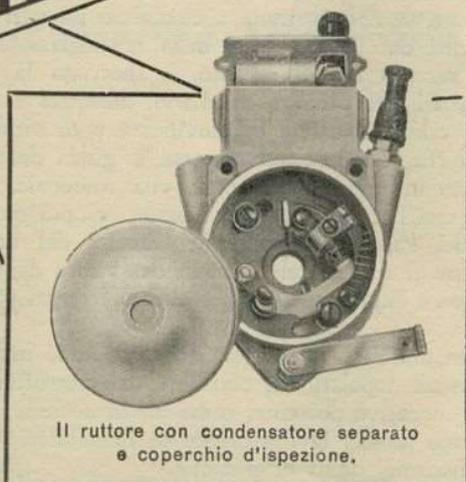
Il rottore con condensatore separato
