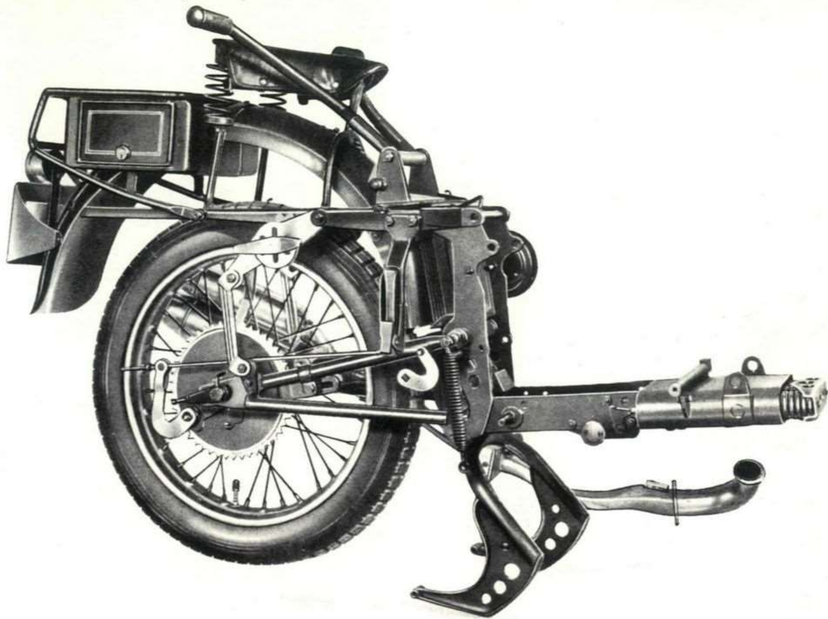
Fig. 28 - Parte posteriore del telaio
