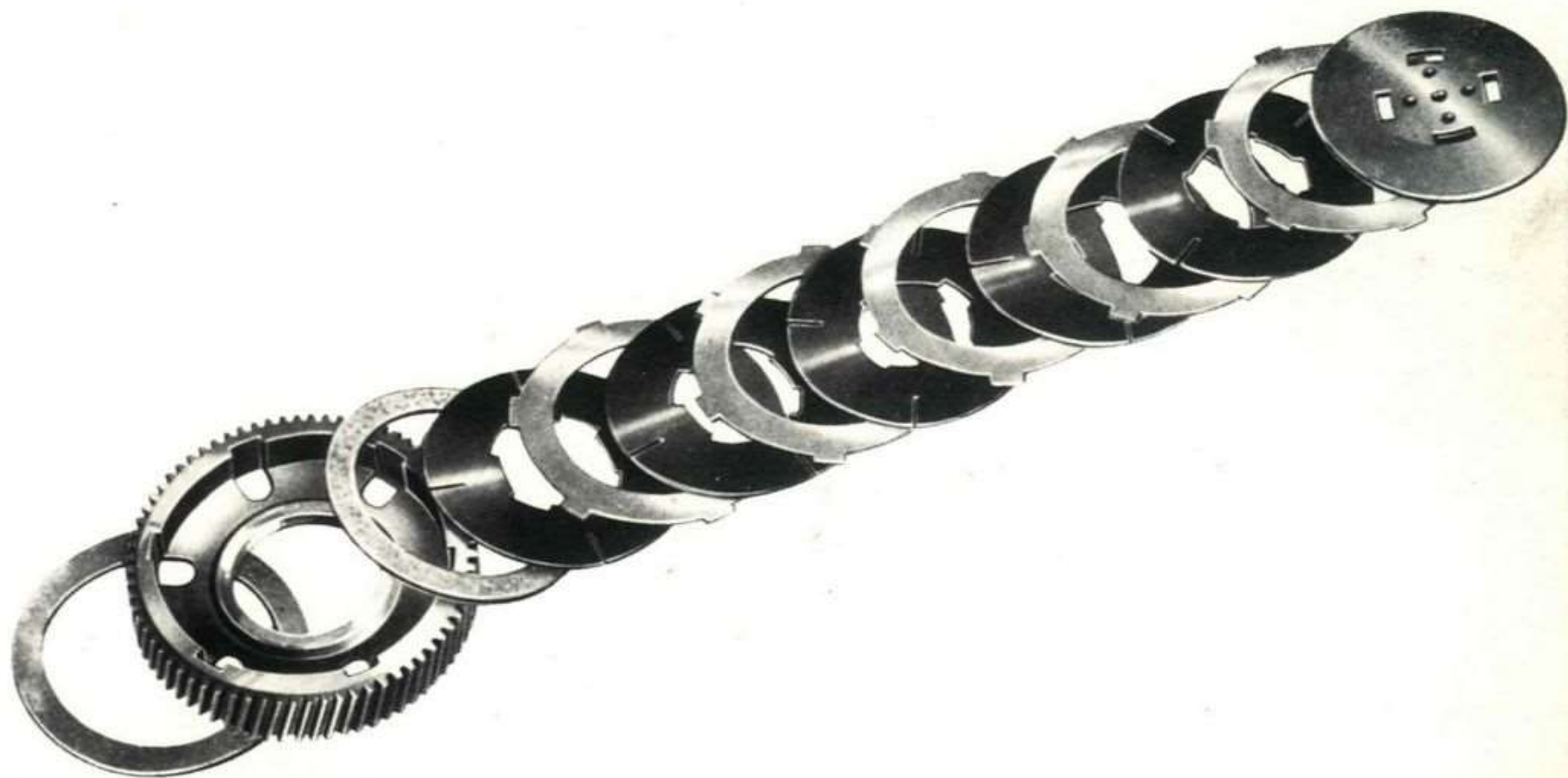
Fig. 20 - Frizione smontata (osservare l'ordine di montaggio dei vari pezzi)
