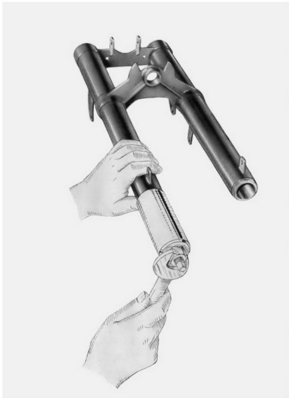
Fig. 69 - Estrazione delle boccole inferiori dalla forcella telescopica
