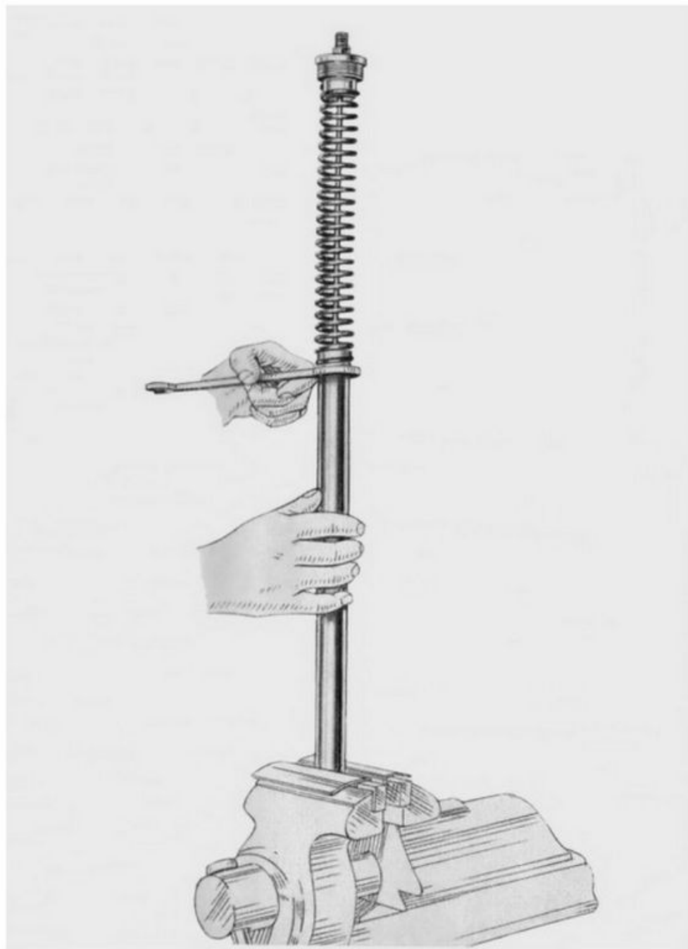
Fig. 66 - Come si svitano i manicotti inferiori per fissaggio molle forcella
