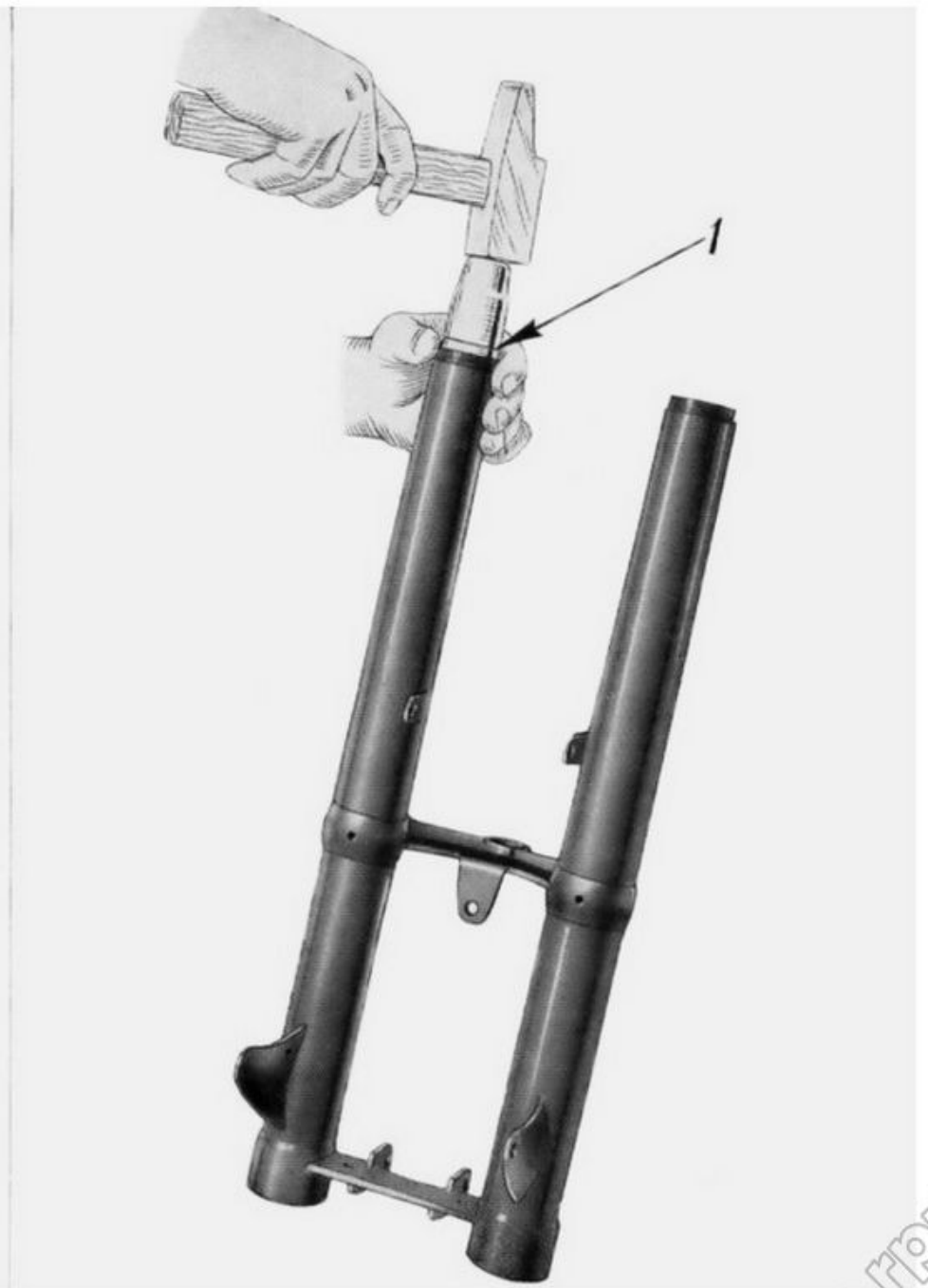
Fig. 70 - Montaggio delle boccole superiori nella forcella telescopica
