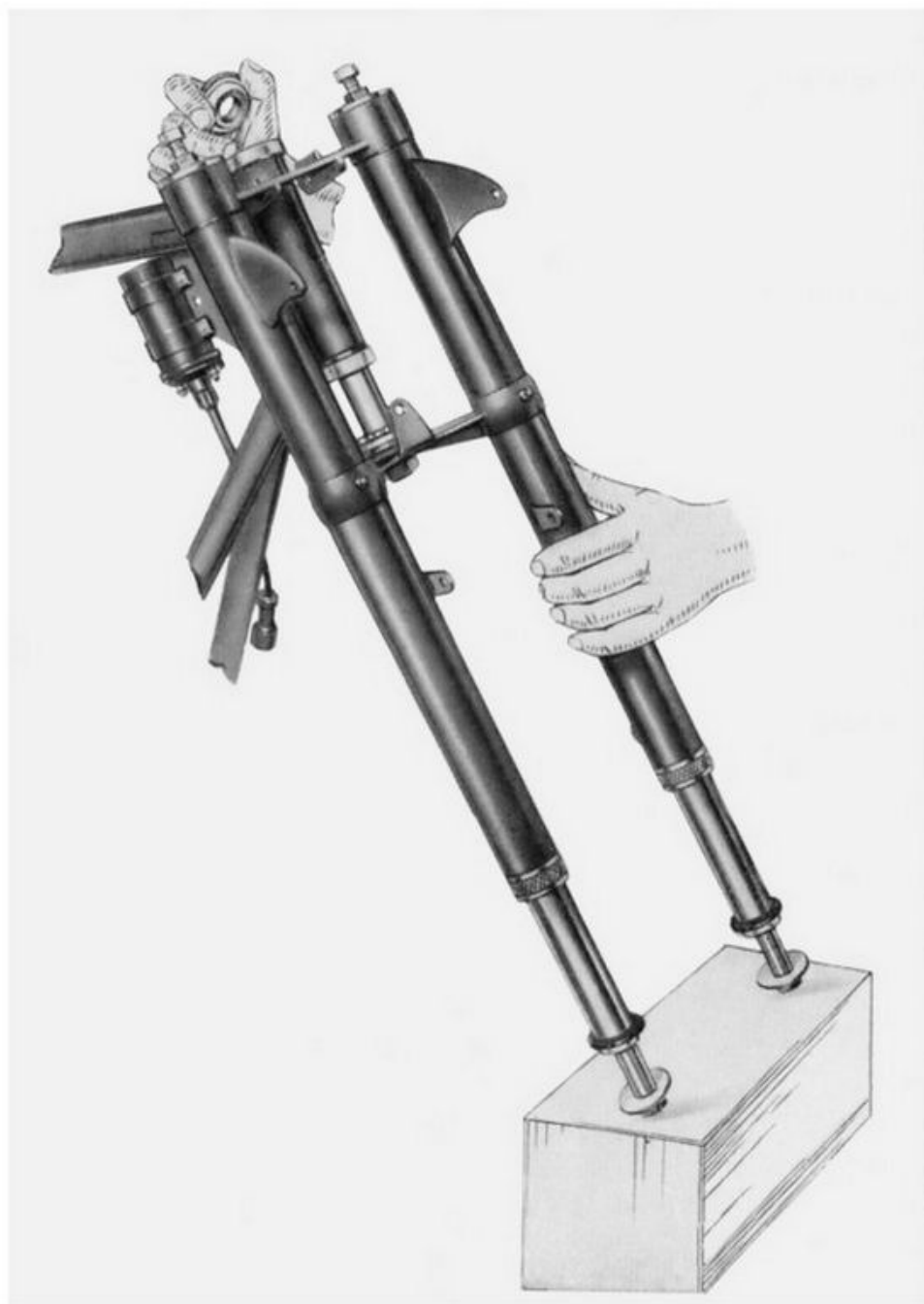
Fig. 64 - Smontaggio della forcella telescopica dal telaio
