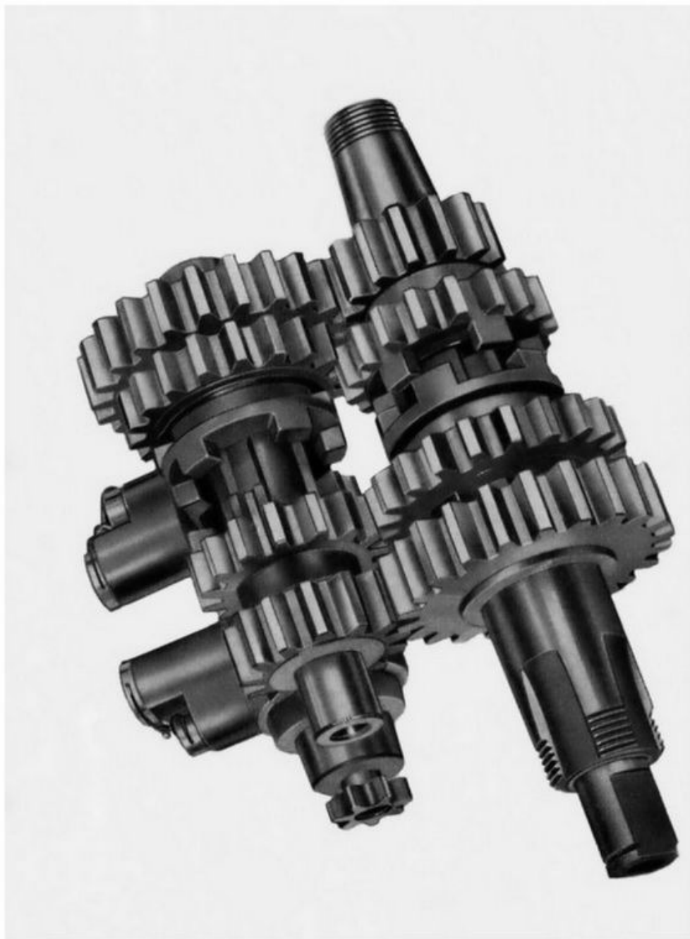
Fig. 48 - Gruppo cambio montato in 1ª velocità
