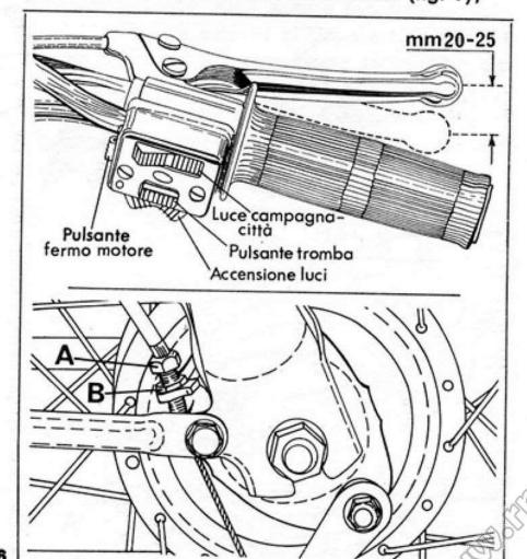
■ registrare la tensione catena, dopo avere allentato i dadi «A» sul perno ruota posteriore avvitare o svitare i dadi sui tendicatena «B». Scuotimento nella parte centrale della catena (con il ciclomotore giù dal cavalletto) mm 25-30 e centrare la ruota (fig. 8);
