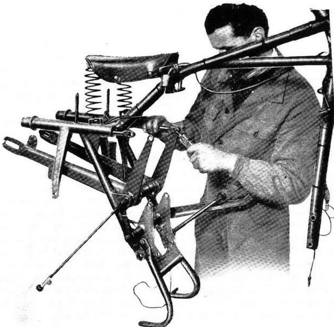
Fig. 36 - Montaggio del tirante
