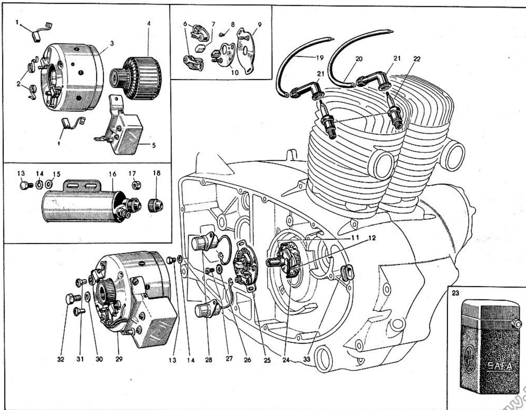
Tav. 16 — IMPIANTO ELETTRICO - Dinamo - Ruttore - Anticipo automatico - Batteria - Bobina
