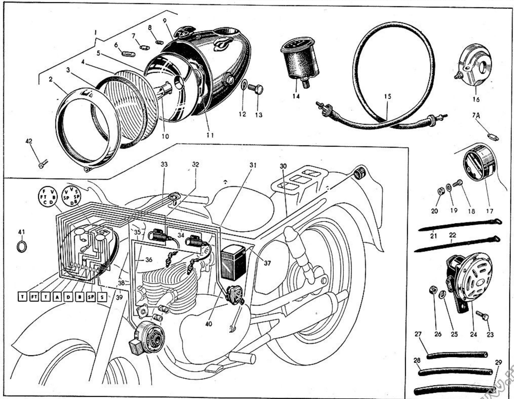
Tav. 17 — IMPIANTO ELETTRICO - Fanaleria e tromba elettrica - Connessioni e schema impianto elettrico - Contachilometri
