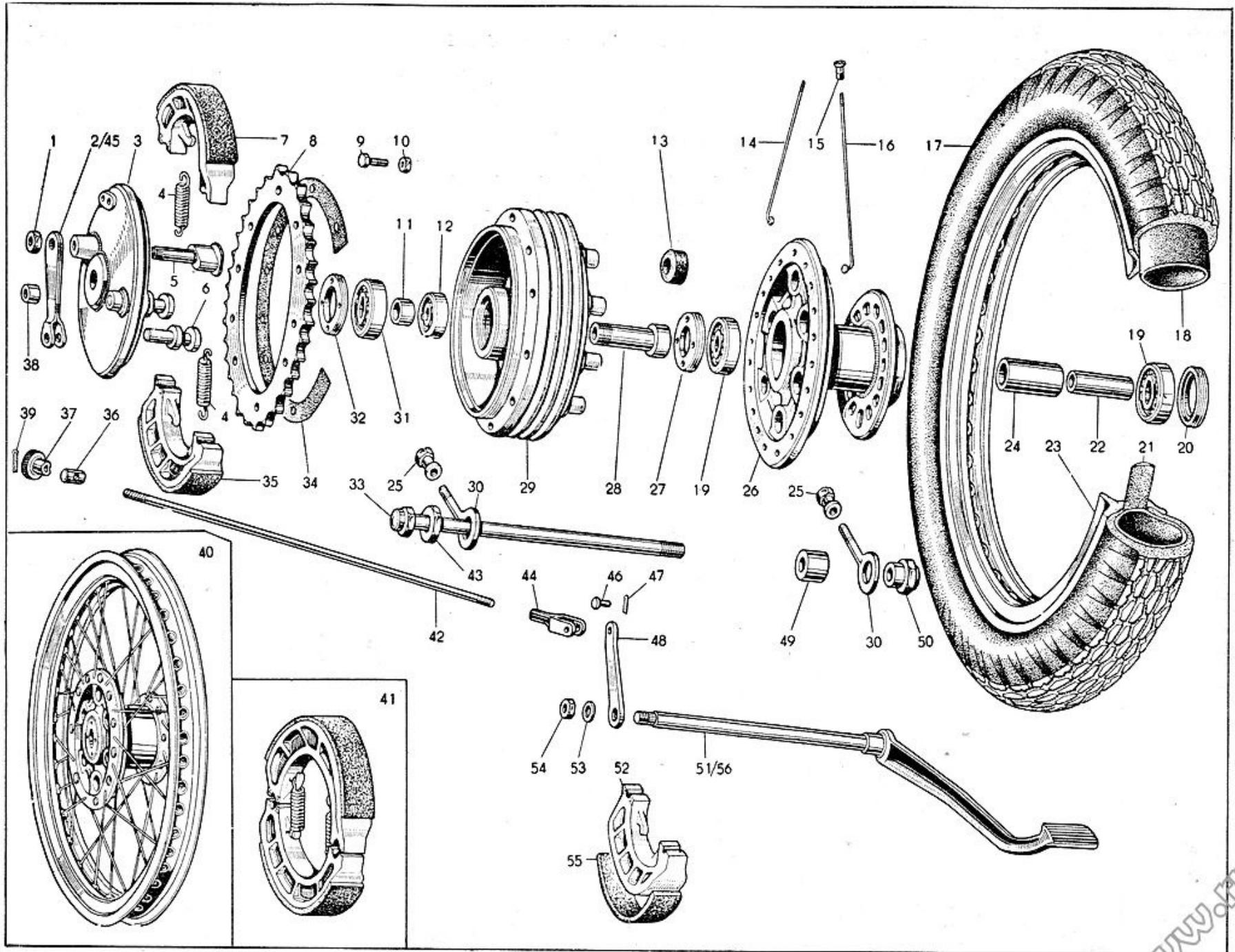
Tav. 14 — MOTOTELAIO - Ruota posteriore, freno e comando
