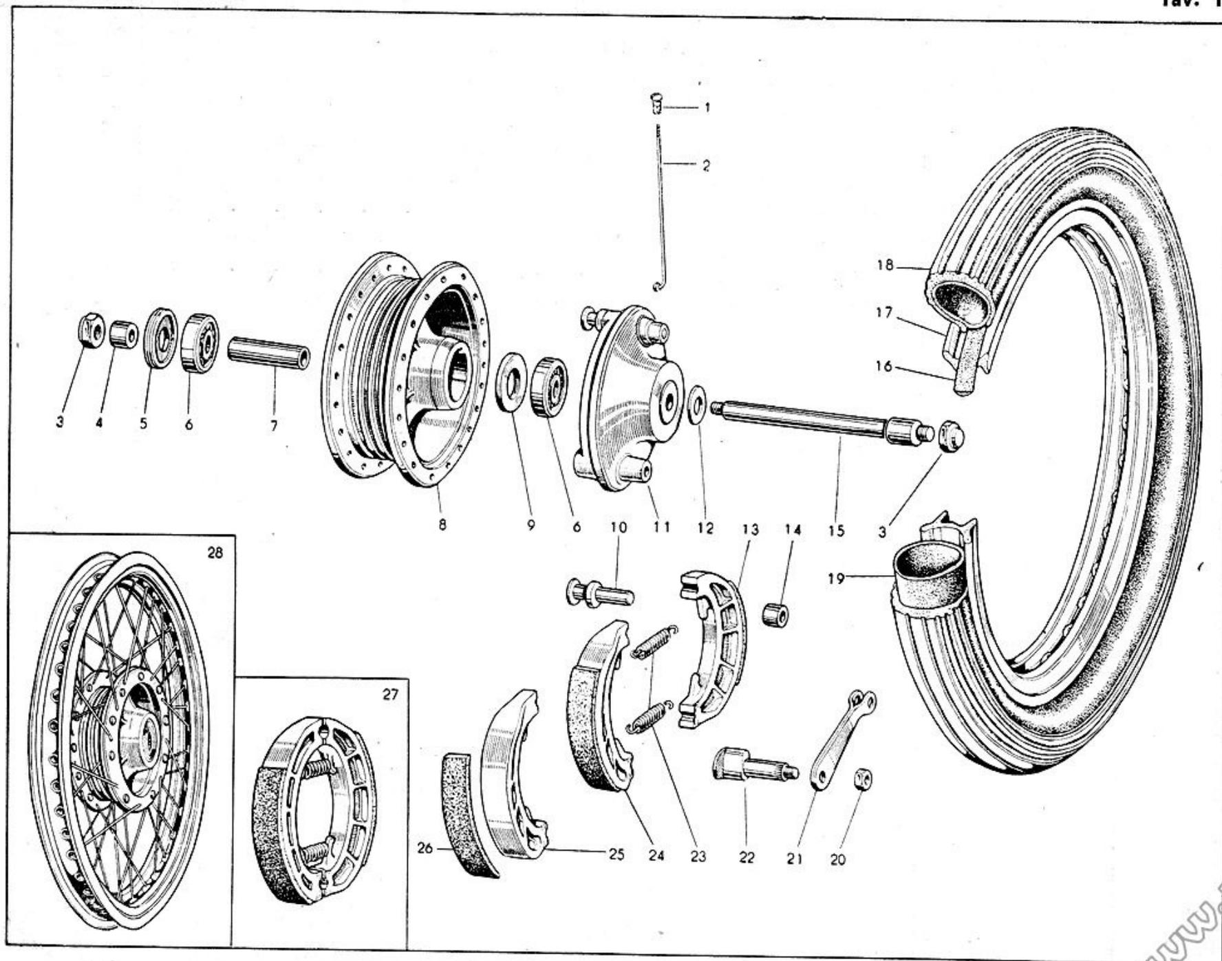
Tav. 13 — MOTOTELAIO - Ruota anteriore e freno
