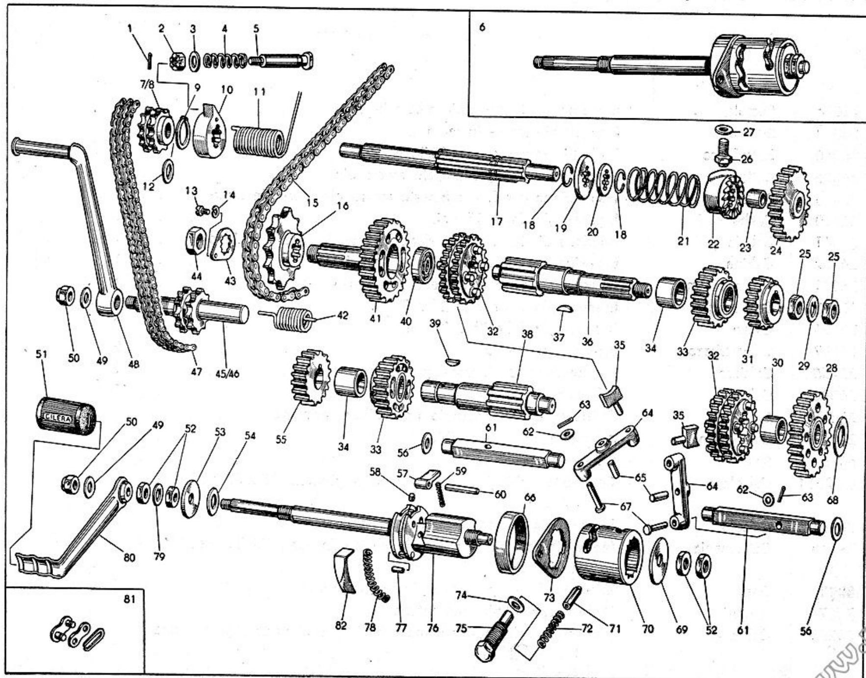
Tav. 7 — MOTORE - Alberi ed ingranaggi del cambio - Selettore - Messa in moto - Catena trasmissione posteriore
