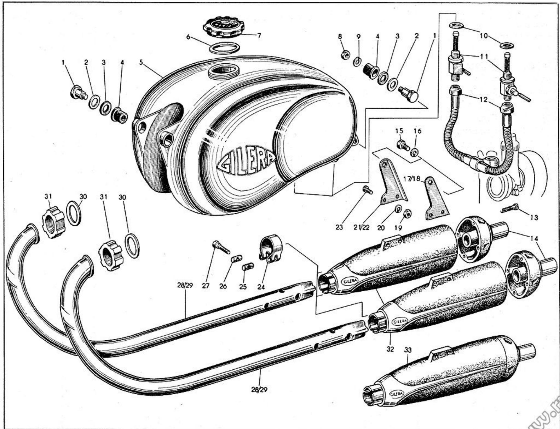
Tav. 9 — MOTORE - Serbatoio carburante - Tubo scarico e silenziatore
