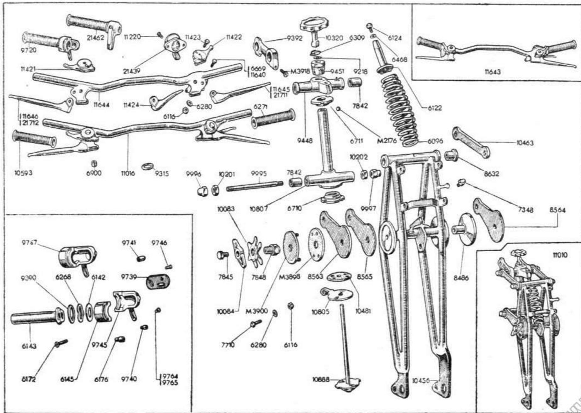
Tav. 13 - TELAIO - RUOTE - FRENI - Ruota anteriore, freno e comando
