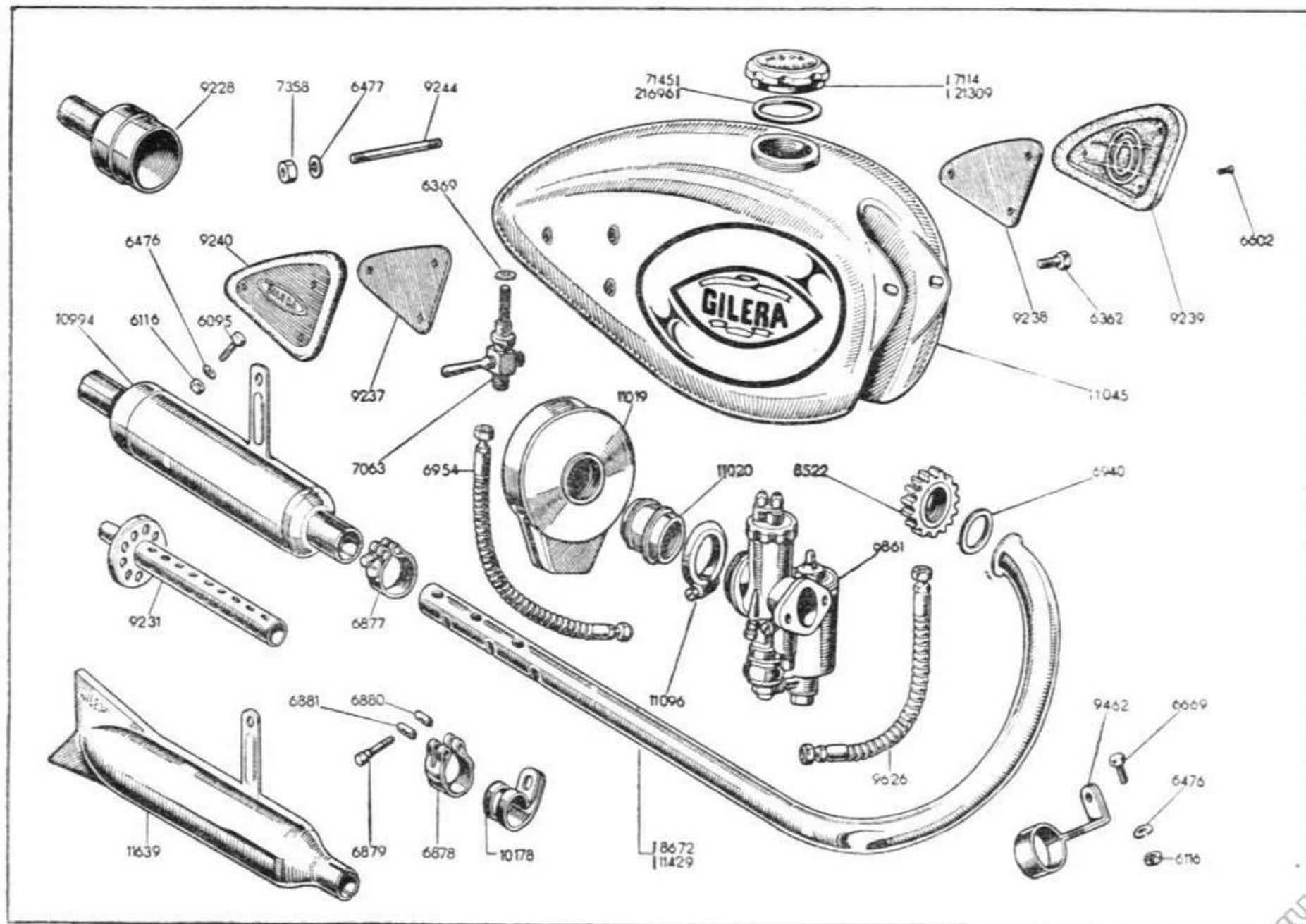
Tav. 6 - MOTORE - Serbatoio carburante - Carburatore - Silenziatore
