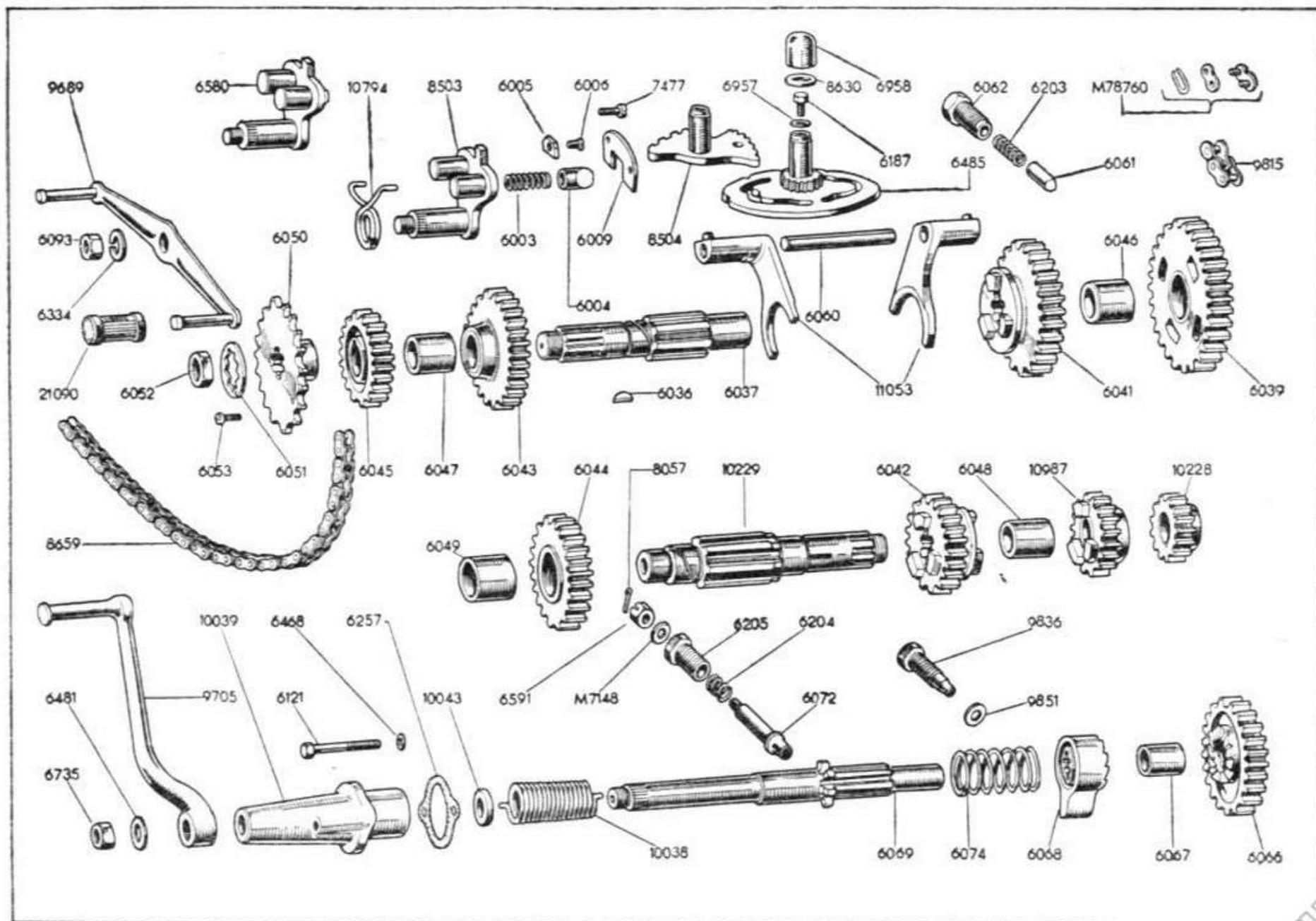
Tav. 10 - MOTORE - Alberi ed ingranaggi del cambio - Selettore - Messa in moto - Catena trasmiss.
