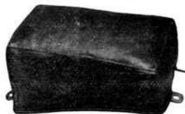
1438 Tipo B. S. A. in pegamoide, imbottito con crine metallizzato, con attacco metallico diretto al parafango . . . . . L.
