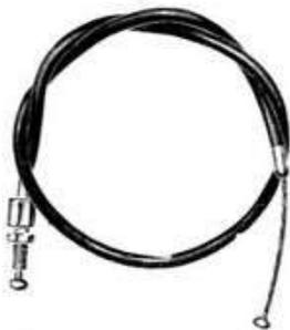
2277 Trasmissione per comando farfalla completa di tirafilo L.
