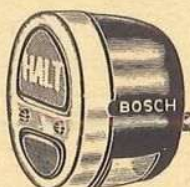
Bild 2 Brems-Schluß-Nummer-Laterne Q 80 S 108
