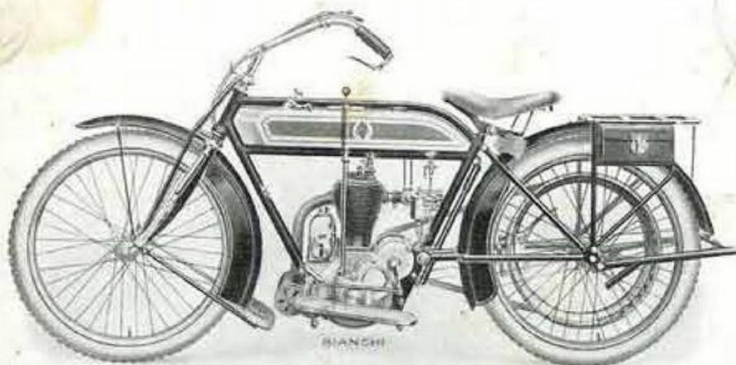
**Motore** :: Monocilindrico di 498 cm.<sup>3</sup> di cilindrata (alesaggio mm. 75 corsa mm. 112) 3 1/2 - 4 HP. - a valvole laterali - montato su cuscinetti a sfere di grande diametro - con lubrificazione semiautomatica - perfettamente raffreddato.
