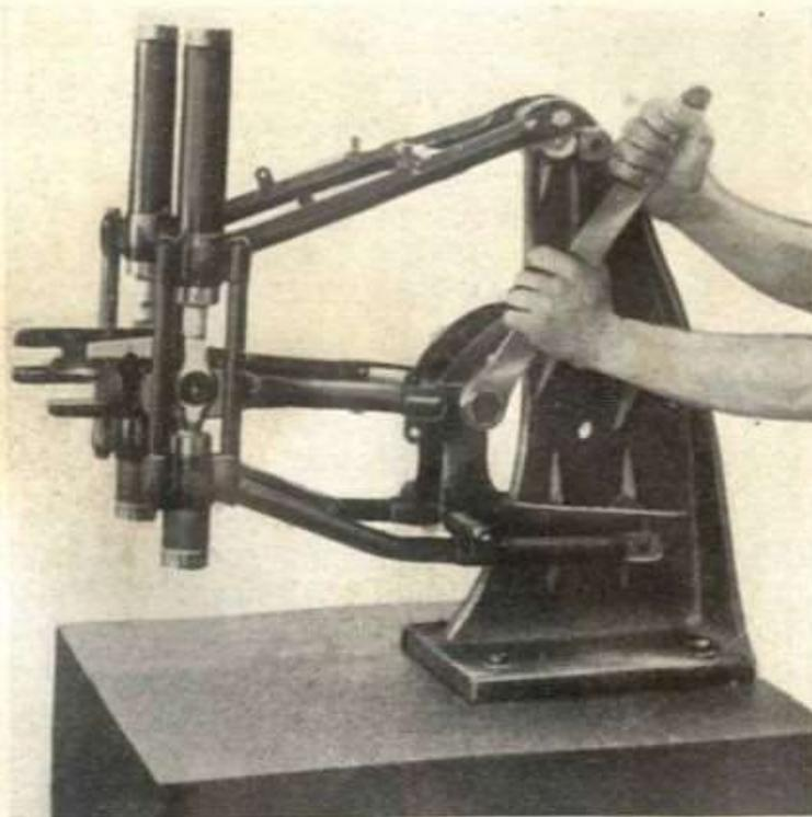
Fig. 122 - **A 41** Chiave smontaggio dadi perno unione bracci elastici
