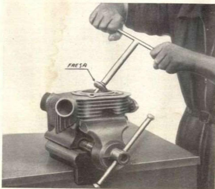
Fig. 42 - **A 17 - 17 a** Utensile a forma di fresa per ripassatura sedi valvole
