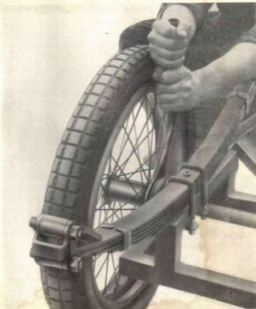
Fig. 102 - **A 33** Chiave piatta sbloccaggio e smontaggio ruote
