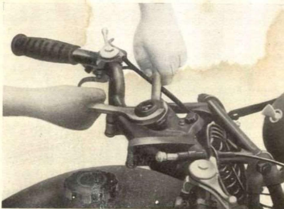
Fig. 118 - **A 38-39** Chiavi speciali smontaggio sterzo
