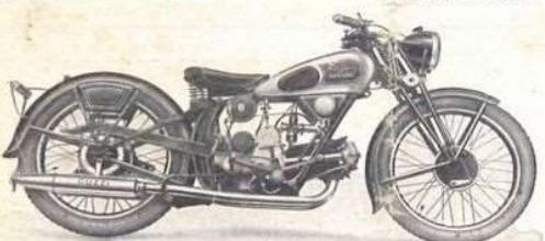
**Tipo W** Alesaggio mm. 88 - corsa mm. 82 - cilindrata cm. 499 - testa del cilindro smontabile, emisferica - valvole ambidue in testa, inclinata - cambio a quattro velocità, comandato a pedale - frizione a dischi metallici - accensione a magnete - catena 5/8 X 1/4 - gomme Pirelli: anteriore 3,00 X 20 rigato, posteriore 3,25 X 20 - serbatoi: benzina litri 12, olio litri 2,5 - freni ad espansione sulle due ruote - velocità km. 140.
