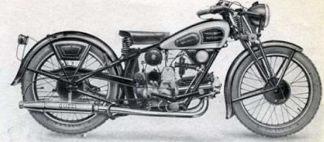
Tipo W Alessagio mm. 88 - Corsa mm. 82 - Cilindrata cm. 499 - Testa del cilindro smontabile, emisferica - Valvole ambidue in testa, inclinate - Cambio a 4 velocità comandato a pedale - Frizione a dischi metallici - Accensione a magnete - Catena 5/8 X 1/4 - Gomme Pirelli anteriori 3,30 X 19, posteriori 3,30 X 19 - Serbatoio benzina litri 12, olio litri 2,10 - Freni ad espansione sulle due ruote - Velocità Km. 100 PREZZO L. 8.200
