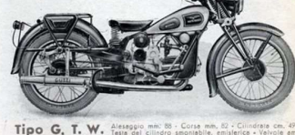
Tipo G. T. W Alessagio mm. 88 - Corsa mm. 82 - Cilindrata cm. 499 - Testa del cilindro smontabile, emisferica - Valvole ambidue in testa, inclinate - Cambio a 4 velocità comandato a pedale - Frizione a dischi metallici - Accensione a magnete - Catena 5/8 X 1/4 - Gomme Pirelli anteriori 3,35 X 19, posteriori 3,35 X 19 - Serbatoio benzina litri 12, olio litri 2,10 - Freni ad espansione sulle due ruote - Velocità Km. 140 - Il telaio è sospeso elasticamente anche posteriormente, col sistema brevettato Moto Guzzi che assicura una incomparabile dolcezza di marcia anche su strade a fondo irregolare. PREZZO L. 9.250
