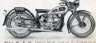
Tipo G. T. V Alessagio mm. 88 - Corsa mm. 82 - Cilindrata cm. 499 - Testa del cilindro smontabile, emisferica - Valvole ambidue in testa, inclinate - Cambio a 4 velocità comandato a pedale - Frizione a dischi metallici - Accensione a magnete - Catena 5/8 X 1/4 - Gomme Pirelli anteriori 3,30 X 19, posteriori 3,30 X 19 - Serbatoio benzina litri 12, olio litri 2,10 - Freni ad espansione sulle due ruote - Velocità Km. 100 - Il telaio è sospeso elasticamente anche posteriormente, col sistema brevettato Moto Guzzi che assicura una incomparabile dolcezza di marcia anche su strade a fondo irregolare. PREZZO L. 8.300
