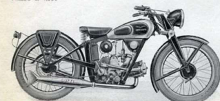
Tipo P. E. 250 Alessagio mm. 70 - Corsa mm. 64 - Cilindrata cm. 247 - Testa del cilindro smontabile, emisferica - Valvole ambidue in testa, inclinate - Cambio a 3 velocità comandato a mano con valvola a lecca e a pedale con pignone - Frizione a dischi metallici - Accensione a magnete - Catena 5/8 X 1/4 - Gomme Pirelli anteriori 3,30 X 19, posteriori 3,30 X 19 - Serbatoio benzina litri 10,10, olio litri 2,10 - Freni ad espansione sulle due ruote - Velocità Km. 100 PREZZO L. 4.900
