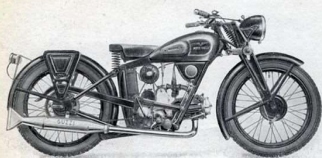
Tipo P. L. 250 Alessagio mm. 70 - Corsa mm. 64 - Cilindrata cm. 247 Testa del cilindro smontabile, emisferica - Valvole ambidue in testa, inclinate - Cambio a 3 velocità comandato a mano con valvola a lecca e a pedale con pignone - Frizione a dischi metallici - Accensione a magnete - Catena 5/8 X 1/4 - Gomme Pirelli anteriori 3,30 X 19, posteriori 3,30 X 19 - Serbatoio benzina litri 10,10, olio litri 2,10 - Freni ad espansione sulle due ruote - Velocità Km. 100 PREZZO L. 4.350
