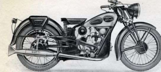
Tipo P. E. 250 Alessagio mm. 70 - Corsa mm. 64 - Cilindrata cm. 247 - Testa del cilindro smontabile, emisferica - Valvole ambidue in testa, inclinate - Cambio a 3 velocità comandato a mano con valvola a lecca e a pedale con pignone - Frizione a dischi metallici - Accensione a magnete - Catena 5/8 X 1/4 - Gomme Pirelli anteriori 3,30 X 19, posteriori 3,30 X 19 - Serbatoio benzina litri 10,10, olio litri 2,10 - Freni ad espansione sulle due ruote - Velocità Km. 100 - Il telaio è sospeso elasticamente anche posteriormente, col sistema brevettato Moto Guzzi che assicura una incomparabile dolcezza di marcia anche su strade a fondo irregolare. PREZZO L. 5.700
