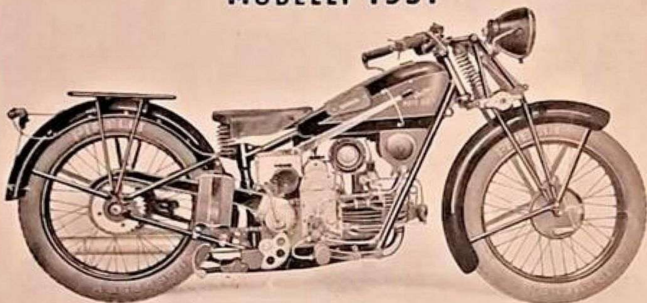
Tipo SPORT 15 con impianto a dinamo separata - Lato distribuzione
