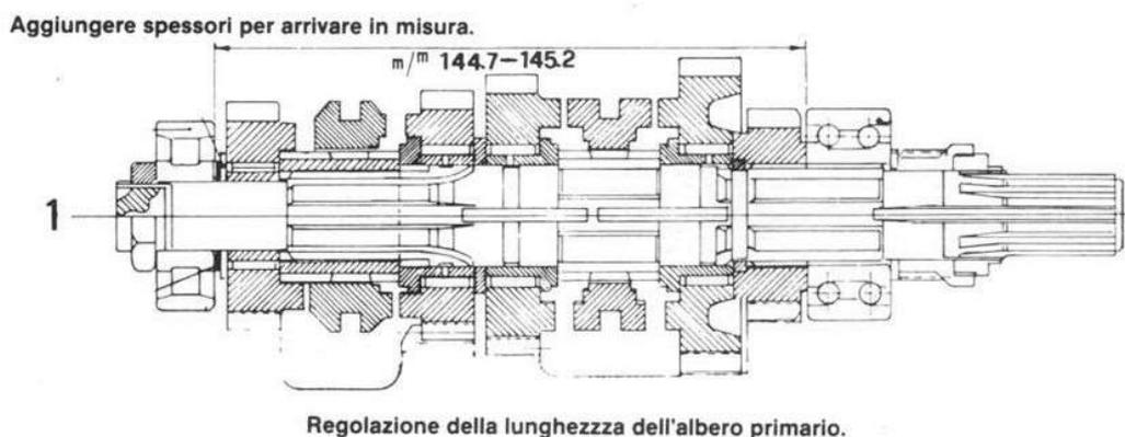
Fig. 2.3 Regolazione della lunghezza dell'albero primario e secondario.
