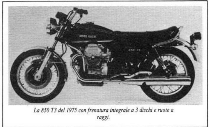
La 850 T3 del 1975 con frenatura integrale a 3 dischi e ruote a raggi.
