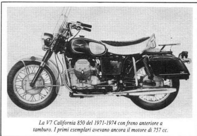
La V7 California 850 del 1971-1974 con freno anteriore a tamburo. I primi esemplari avevano ancora il motore di 757 cc.
