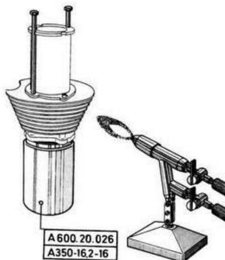
Fig. 22 EINSETZEN EINER NEUEN ZYLINDERBUECHSE INTRODUCTION D'UNE CHEMISE DE CYLINDRE NEUVE
