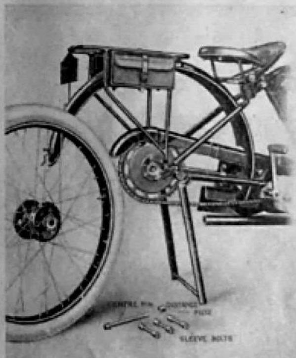
Ruota posteriore A.J.S. (Brevettata) Smontata.
