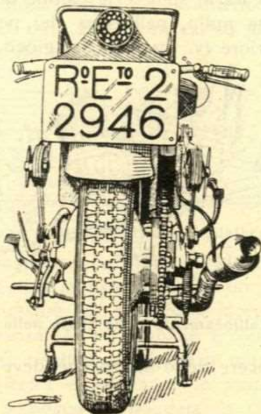
Fig. 47 - Verificare l'allineamento delle ruote nel piano verticale traguardando le ruote stesse dalla parte posteriore
