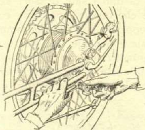
Fig. 43 - Verificare che le bielle di ancoraggio si innestino bene nei rispettivi pomoli
