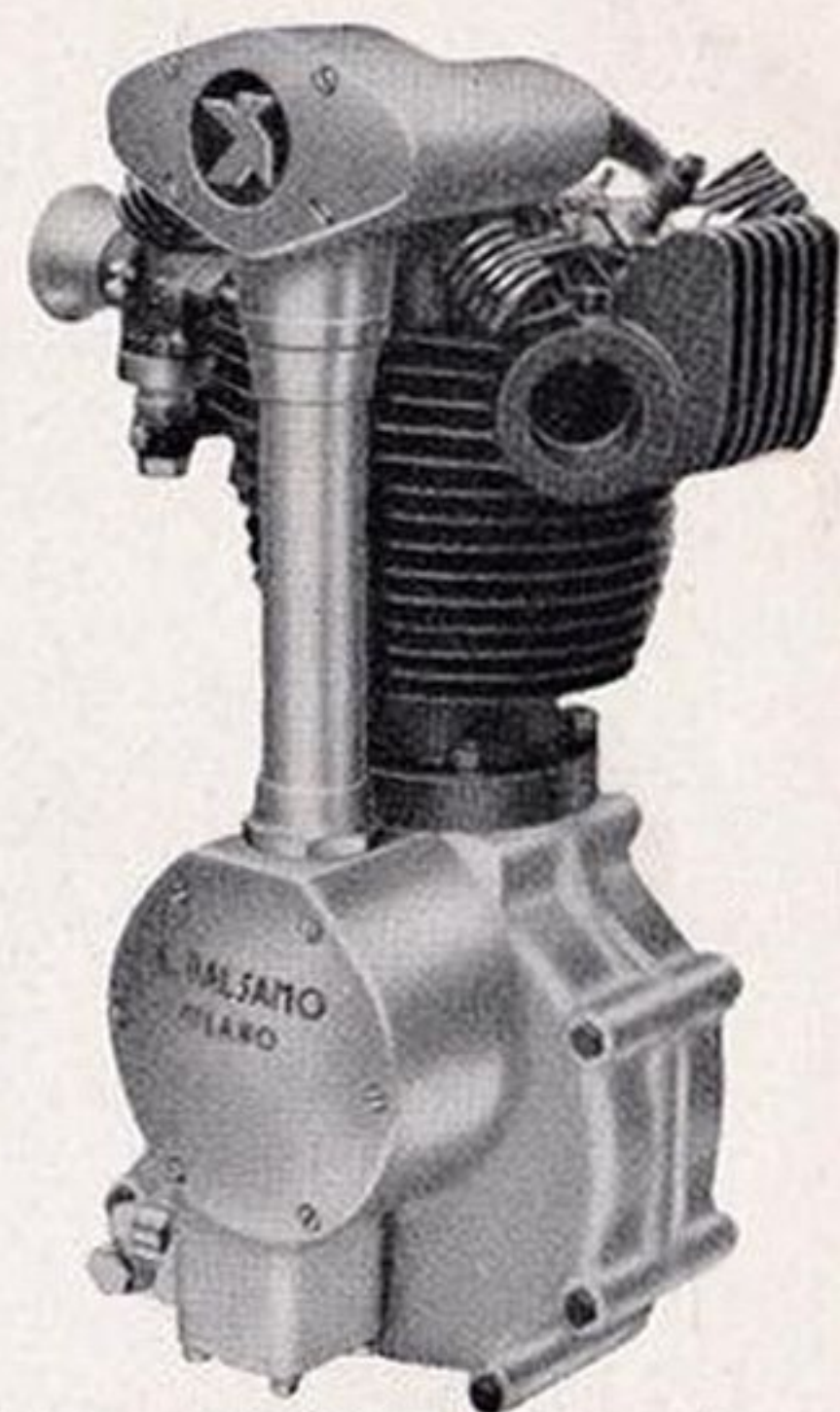
Motore "BALSAMO" 500 cc. e il si- stema di molle a spillo di richiamo delle valvole.
