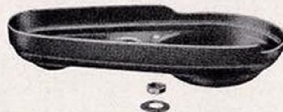
Carter catena a bagno d'olio a perfetta tenuta e che racchiude anche la trasmis- sione di comando della dinamo. - Il car- ter è di facilissimo smontaggio, essendo fissato con un solo bullone.
