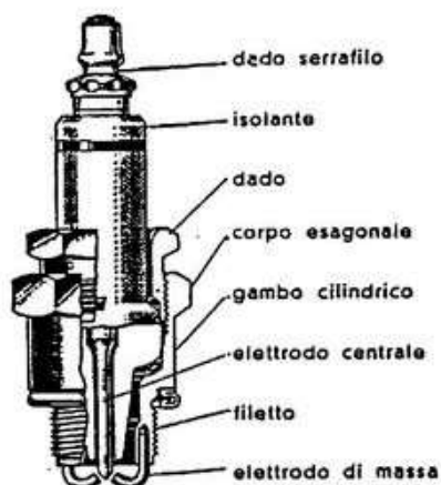
Sezione di una candela smontabile con isolante di porcellana
